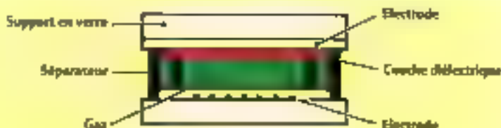
Fig. 2. - Écran à plasma/courant alternatif (couplage capacitif du gaz avec les conducteurs).
